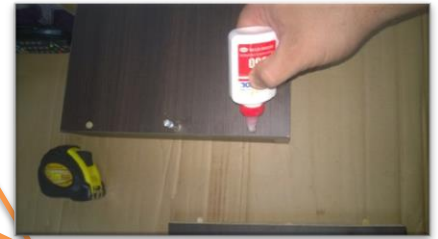
Posición de 2 conectores minifix
